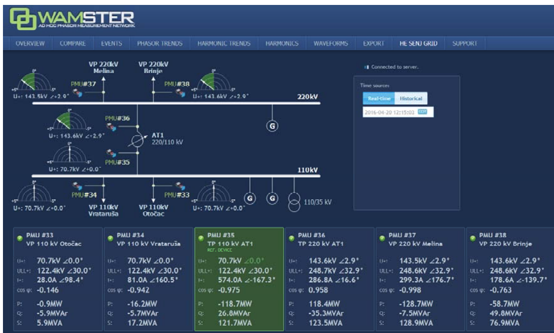
Slika 1. Tokovi snaga u stvarnim prijenosnim vodovima snimljeni u platformi WAMSTER
